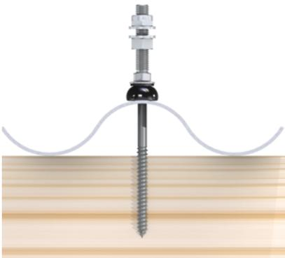
**Wellfaserzement:** Solarbefestiger Typ BZ (EPDM Schirmdichtung)
