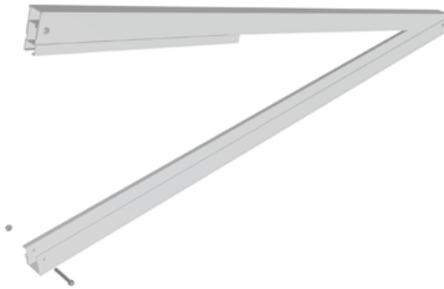
Rückenstütze ausklappen und unteres Ende so in die Bodenschiene einschieben, dass die Löcher übereinander zu liegen kommen.
