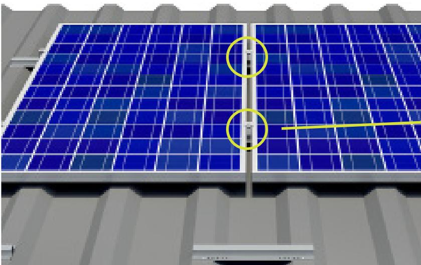
Faites glisser le module en dessous et serrez le support du module.
